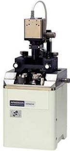
Un modèle compact, polyvalent et multi-modes. La fonction unique « Self Sensing Detector » procure une très grande facilité d'utilisation. Il n'est en effet pas nécessaire d'utiliser un laser pour aligner le détecteur.
