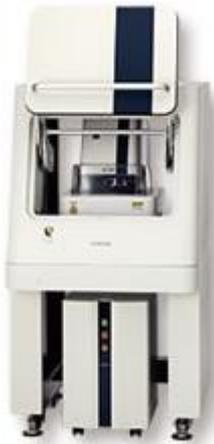
Un modèle pour petits et grands échantillons (platine 100mm motorisée), le 5500 assure un changement des cantilevers automatique. De très nombreux modes sont disponibles. Le 5500 est doté d'une fonctionnalité unique « SAEMIC » pour la corrélation parfaite d'images AFM et celles obtenues sur plusieurs modèles de MEB Hitachi dont le Regulus (MEB FEG Ultra Haute Résolution).
